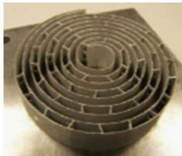
Figura 2-12. Peça industrial fabricada pela tecnologia SLM pelo centro de investigação IK4-LORTEK.
